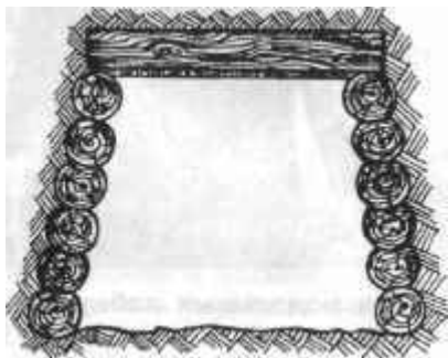
Разрез наиболее древнего подземного хода, выложенного просмоленными сосновыми бревнами.
